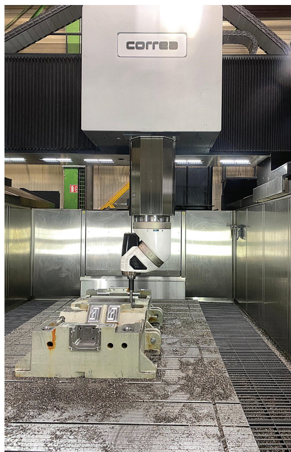
L'imposant béliet de forme octogonale monté sur sa traverse avec les deux rails surplombant la table fixe, l'Xpider a été mise en route début octobre.
